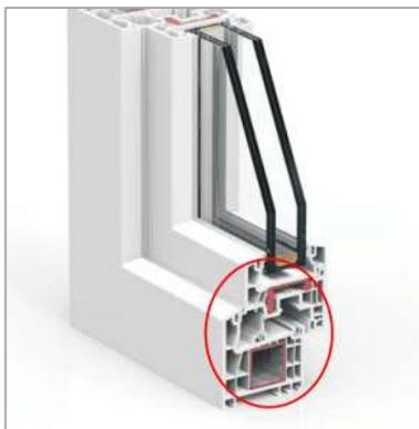
Sistema abisagrado de 70 mm de profundidad de marco y una capacidad máxima de acristalamiento de 40 mm. Su perfilaría de 5 cámaras interiores en marco y hoja, le confiere una gran eficiencia energética con valores de transmitancia desde 0,9 W/m K, convirtiéndolo así en el ventanal idóneo para garantizar el cumplimiento de las normativas más exigentes aplicables a cualquier zona climática.
